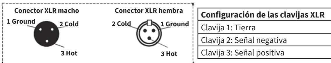
**Terminador DMX:** En aplicaciones donde el cable DMX debe recorrer largas distancias, se recomienda el uso de un terminador para evitar un comportamiento inesperado por parte del equipo. Un terminador es básicamente una resistencia de 1/4 W y 110/120 Ω soldado entre las clavijas 2 y 3 de un conector XLR macho (datos + y datos -). Esta unidad se inserta en el conector XLR hembra de la última unidad de una cadena de equipos. Utilizar un terminador le ayudará a reducir la pérdida de señal.
